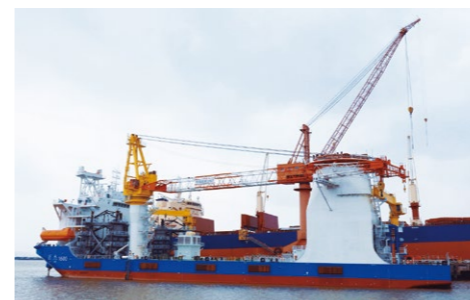
▲ 1600T 自升自航式一体化海上风电安装平台，集起重、运输、储存、居住于一体，“更高、更快”完成海上风电安装
